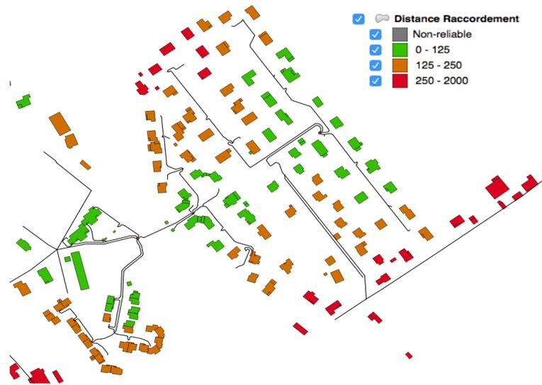
exemple d'analyse croisée du cadastre solaire avec les caractéristiques du réseau basse tension en vert les toitures où le raccordement a le plus de chances d'être économiquement raisonnable
