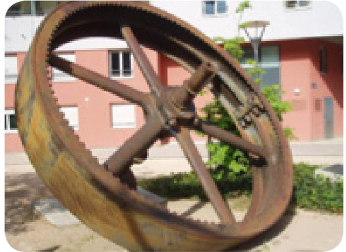
En effet, elle se trouvait dans les usines Rhodia qui produisaient du fil nylon pour fabriquer des textiles ici même à Vaise. Les usines ne devaient jamais s'arrêter. S'il y avait **une panne de courant**, le volant permettait aux machines d'avoir l'élan nécessaire pour continuer à faire tourner le générateur électrique. Ce volant était donc un stockage d'**énergie mécanique** disponible quelques heures.
