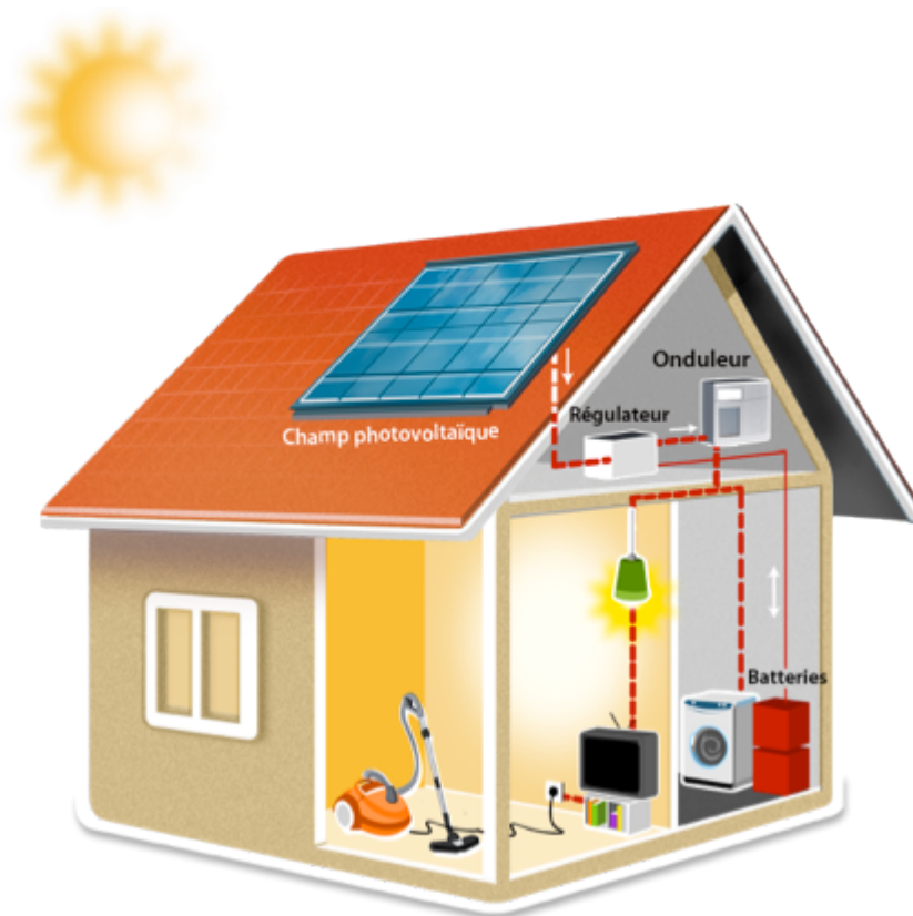
Maison en site isolé / Source : Hespul
